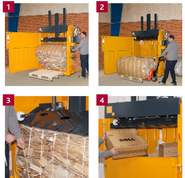
**1** Compacte los residuos y expulse la bala terminada **2** Extraiga y almacene la bala hasta su recogida. **3** El atado a través del plato les permite obtener una bala compacta de alta densidad **4** La abertura de llenado muy ancha les garantiza una carga óptima
