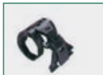
P130001 - BLOCCANTI 40 Dispositivo de bloqueo antirrotura de 40 mm. Disponible para tablillas standard, de tipo mini y de madera. 1 dispositivo de bloqueo cada 1,10 m de persiana.
